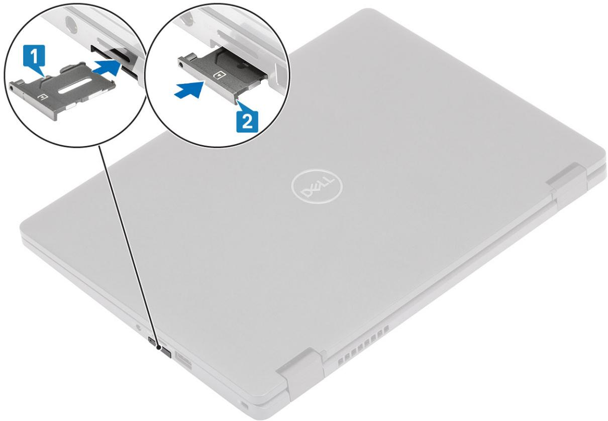
圖 2. 安裝 SIM 卡托盤 (不含 SIM 卡)
