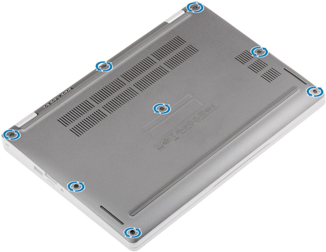
2. 使用塑膠拆殼棒 [1] 從左上角撬起底座護蓋，並繼續撬起兩側以開啟底座護蓋 [2]。
