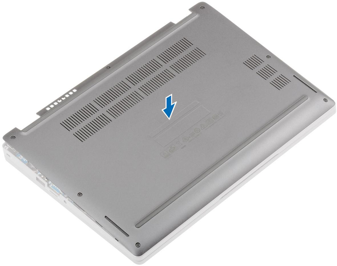
2. 壓下基座護蓋的邊緣和側面，直到卡入定位。
