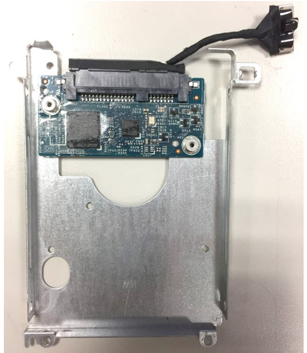
5 اقلب دعامة محرك الأقراص الثابتة، ثم أزل المسامير اللولبية (M2.0)، وأخرج بطاقة eMM من الدعامة.
