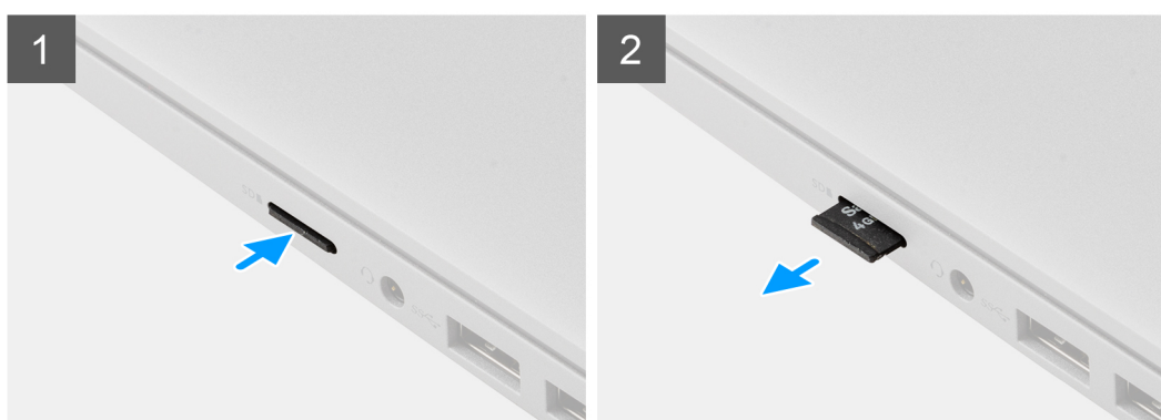
Obrázek 1. Demontáž karty microSD
