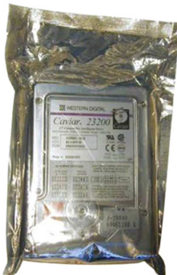
Figura 7. Embalagem contra descargas eletrostáticas
