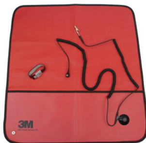
Slika 4. Komplet za servisiranje na terenu u slučaju ESD-a
