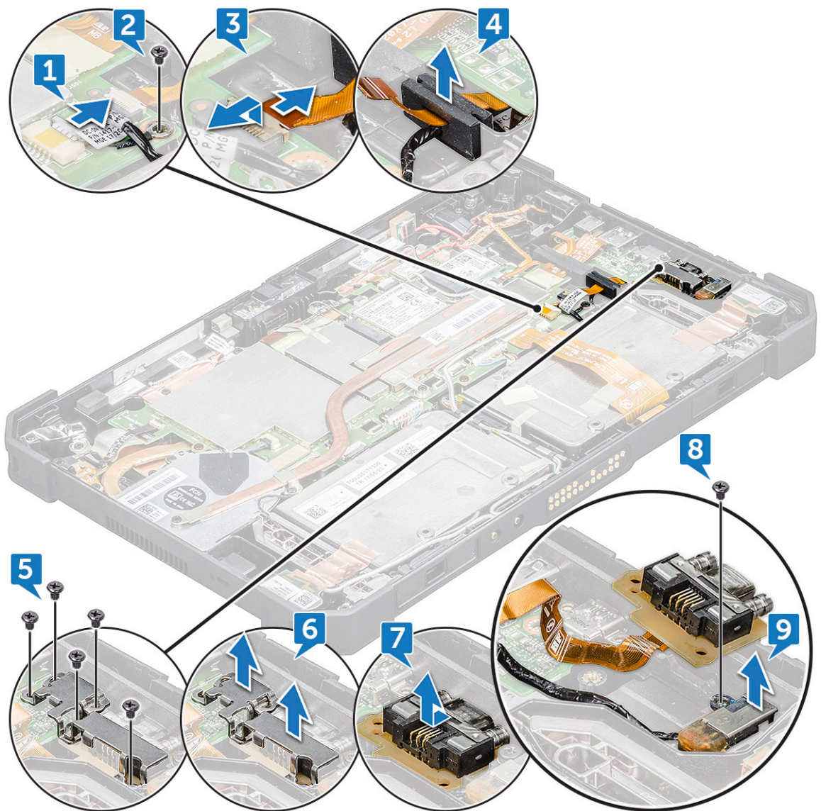
יציאת מחבר החשמל והיציאה הטורית בתצורת Micro מורכבות כרכיב יחיד שיש לחבר ללוח המערכת של מחשב הלוח.
