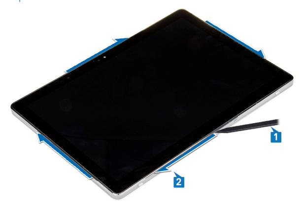
7. ディスプレイパネルを裏返し、LCDパネルを上に向けて平らな場所に置きます。
