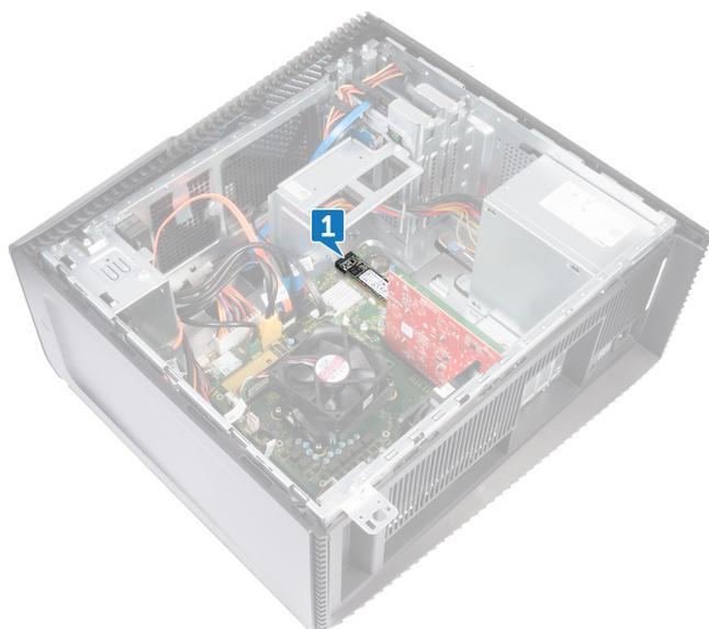
2. Retire o parafuso (M2x3.5) que fixa a unidade de estado sólido à placa de sistema.
