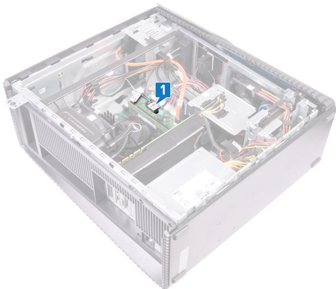
2. Retire o parafuso (M2 x 3,5) que fixa a placa de rede sem fios à placa de sistema.
