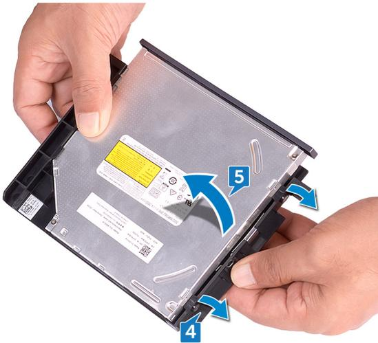
6. 薄型光学ドライブベゼルを光学ドライブから取り外します。
