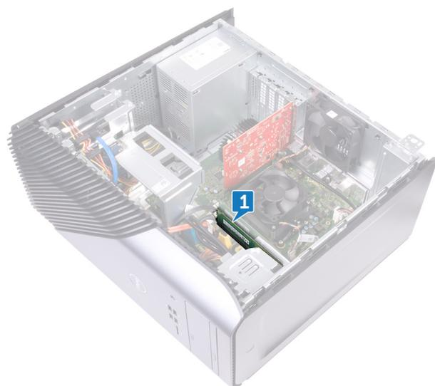
2. メモリモジュールスロットの両端にある固定クリップを、メモリモジュールが持ち上がるまで指先で広げます。
