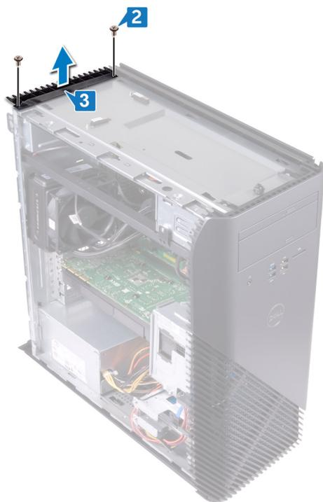
3. 左側シャーシを上向きにしてコンピュータを置き、シャーシのタブから背面カバーのスロットを取り外して、シャーシから背面カバーを取り外します。
