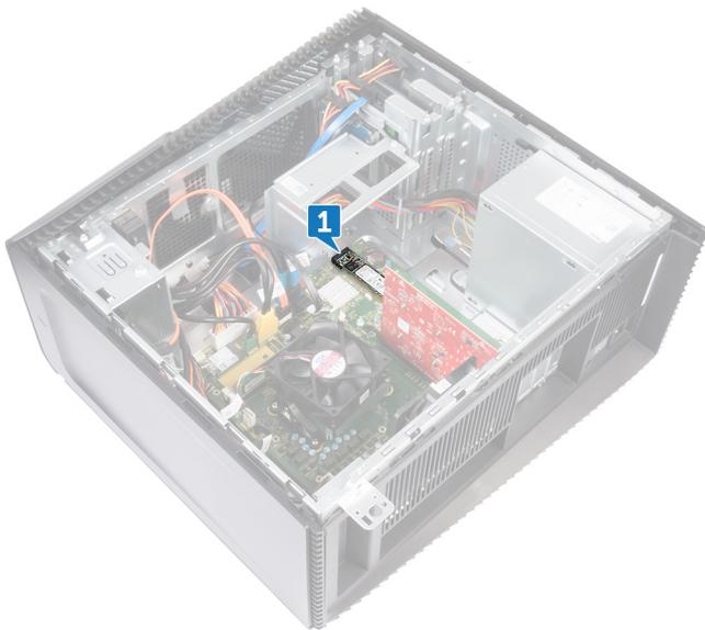
2. ソリッドステートドライブをシステム基板上に固定しているネジ (M2x3.5) を外します。
