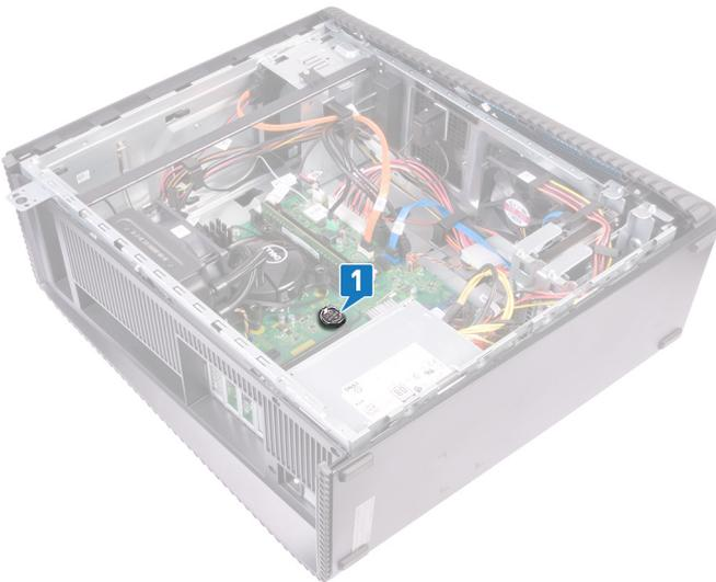
2. コイン型電池ソケットのタブを押します。
