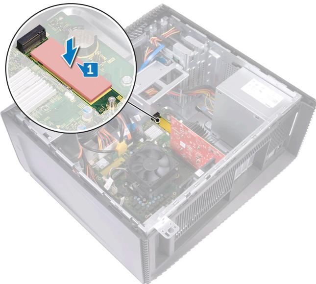
2. ソリッドステートドライブの切り込みをソリッドステートドライブスロットのタブの位置に合わせます。
