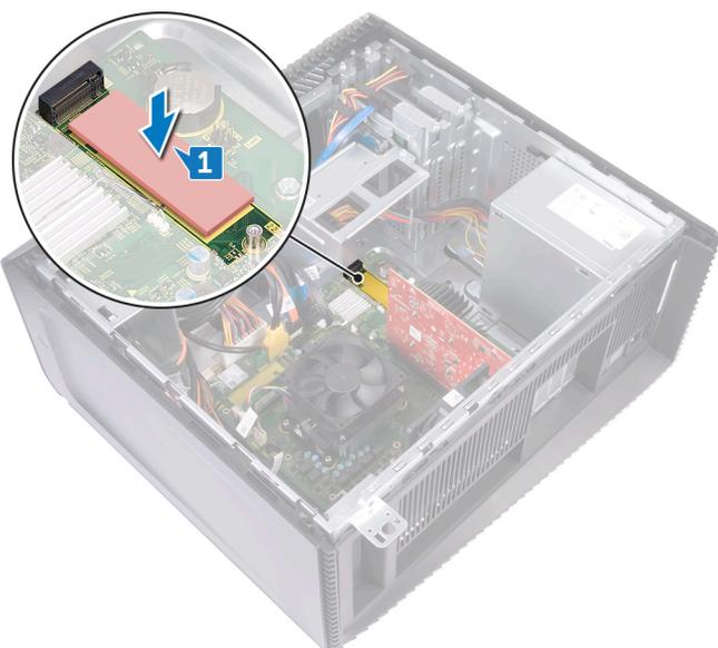
2. Richten Sie die Kerbe auf dem SSD-Laufwerk an der Lasche am SSD-Steckplatz aus.
