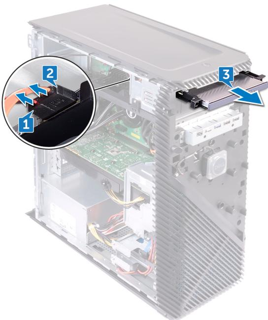
4. Hebeln Sie die Halterung des flachen optischen Laufwerks mit Ihren Fingerspitzen von dem optischen Laufwerk ab.
