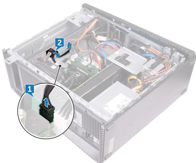
3. Drücken Sie auf die Halterung auf der Betriebsschalterplatine, um das Modul aus der oberen Leiste zu lösen.
