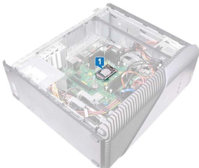
2. Drücken Sie den Entriegelungshebel nach unten und ziehen Sie ihn vom Prozessor weg, um ihn aus der Halterung zu lösen.
