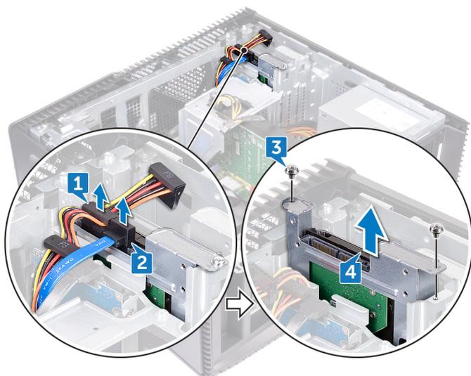
5. Entfernen Sie die vier Schrauben (6-32UNCx3,6), mit denen die Festplattenlaufwerkhalterung an dem Festplattenlaufwerk befestigt ist.
