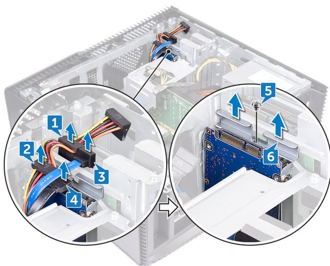
7. Entfernen Sie die vier Schrauben (M3x3,5), mit denen die Festplattenlaufwerkhalterung an der Festplatte befestigt ist.
