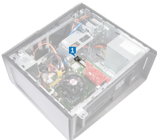
2. Entfernen Sie die Schraube (M2x3.5), mit der das SSD-Laufwerk an der Systemplatine befestigt ist.
