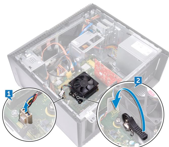
3. Drücken Sie auf den Hebel und lösen Sie diesen aus den Sicherungslaschen auf beiden Seiten des Prozessors.
