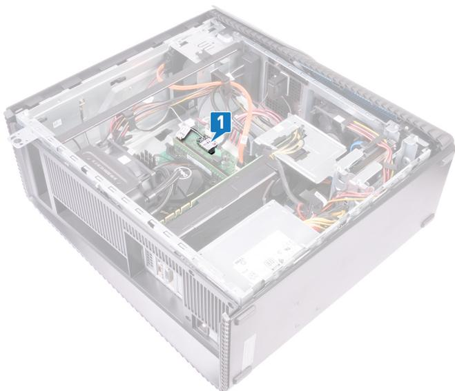
2. Entfernen Sie die Schraube (M2x3,5), mit der die Wireless-Karte an der Systemplatine befestigt ist.
