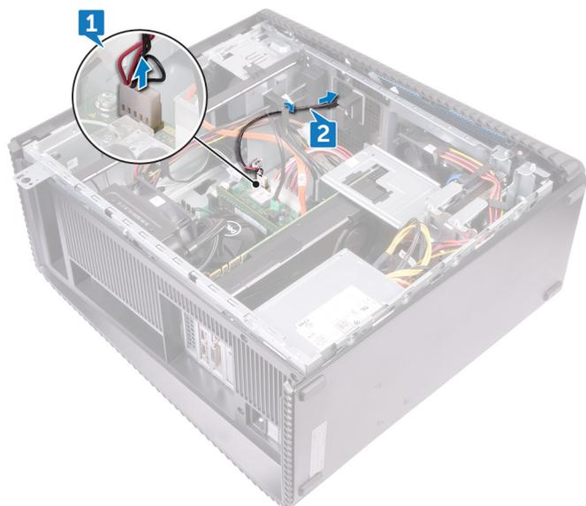
3. Drücken Sie die Lasche, lösen Sie sie aus der Kabelführung am Gehäuse und trennen Sie das Lichtleistenkabel von der Logo-Platine.
