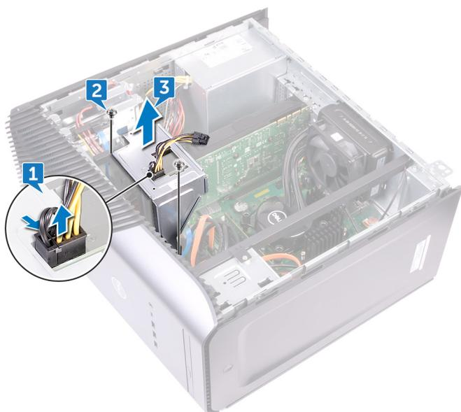
4. Entfernen Sie die zwei Schrauben (6-32UNCx3,6), mit denen die Grafikkarte am Gehäuse befestigt wird.
