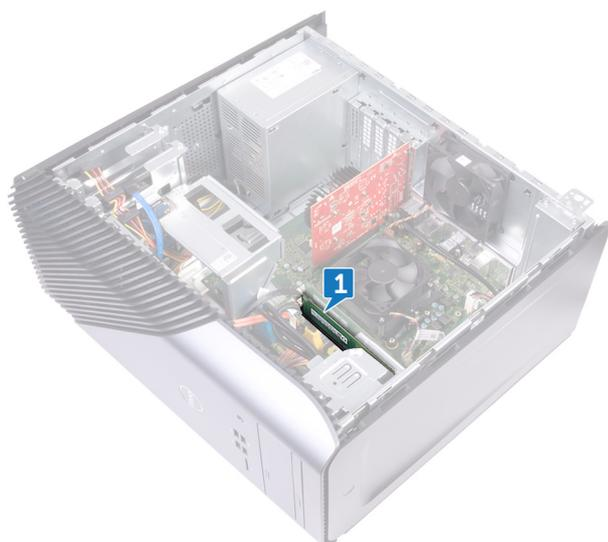
2. Drücken Sie die Sicherungsklammern auf beiden Seiten des Speichermodulsteckplatzes vorsichtig mit den Fingerspitzen auseinander, bis das Speichermodul herauspringt.
