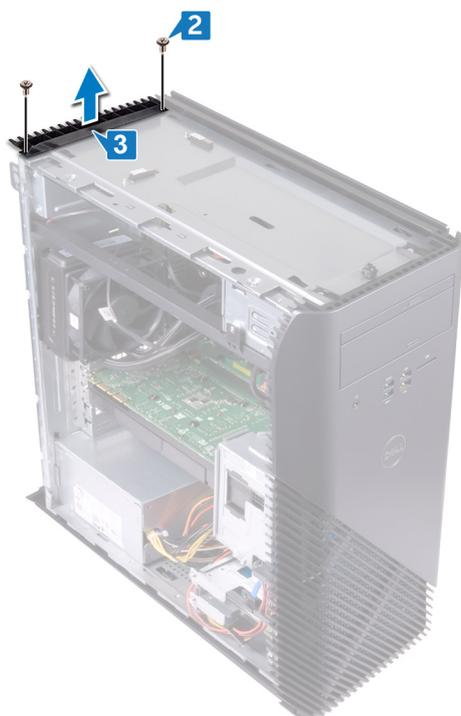
3. Drehen Sie den Computer so, dass die linke Seite des Gehäuses nach oben weist, und lösen Sie die Steckplätze auf der rückseitigen Abdeckung aus den Halterungen am Gehäuse und entfernen Sie die hintere Abdeckung vom Gehäuse weg.
