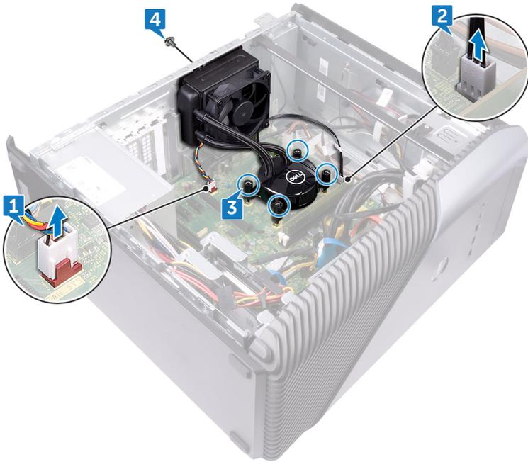
5. Heben und lösen Sie den Lüfter vom Gehäuse.
