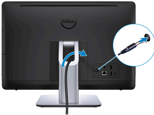
圖 6. 穿過螢幕底座連接電源接頭
