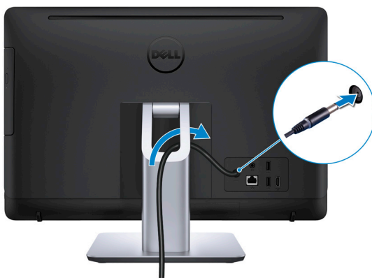
Рисунок 6. Подключение адаптера питания к подставке-основанию
