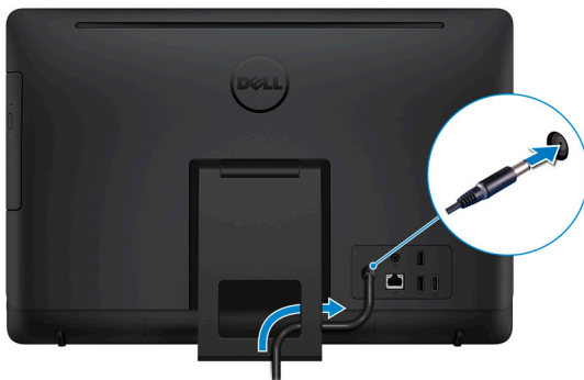
Рисунок 5. Подключение адаптера питания к подставке-стенду
