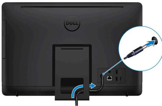
5. ábra. Csatlakoztassa a tápadaptert a kitémasztó állványhoz
