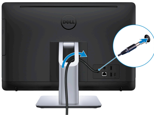
6. ábra. Csatlakoztassa a tápadaptert a talapzattal rendelkező állványhoz
