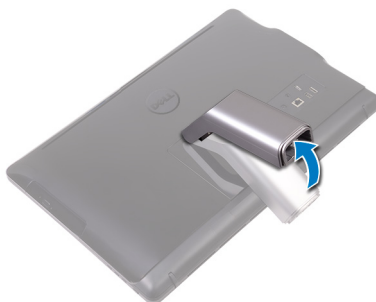
Figure 1. Soulèvement du réhausseur de socle
