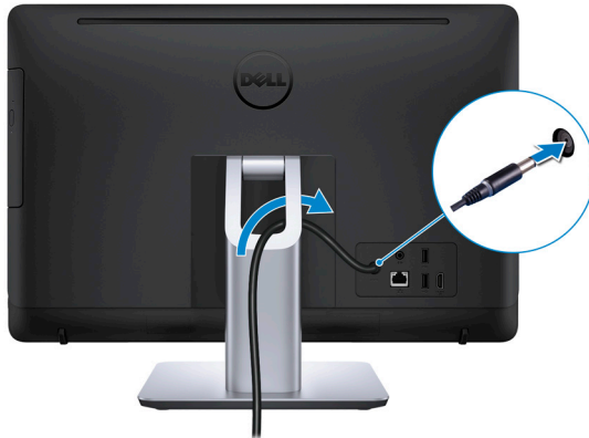
Kuva 6. Virtamuuntajan kytkeminen jalustaan
