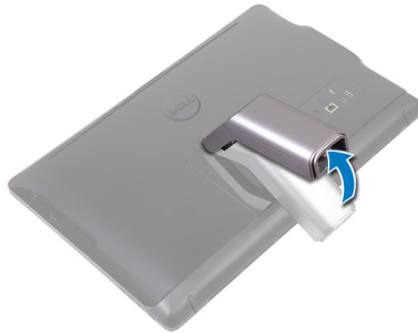
Abbildung 1. Anheben des Standrahmenrisers
