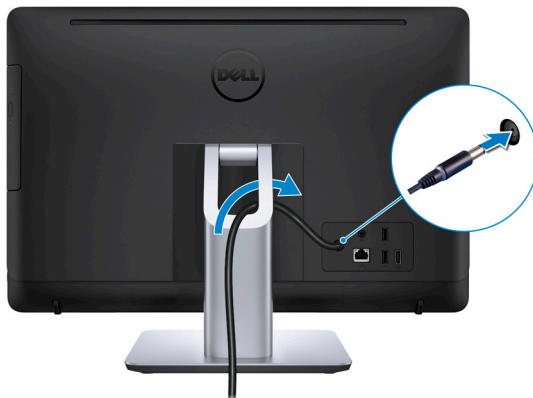
Figur 6. Tilslutning af strømadapteren til piedestalfoden
