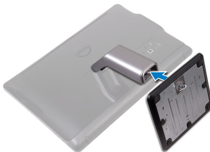
Figur 2. Montering af bunden
