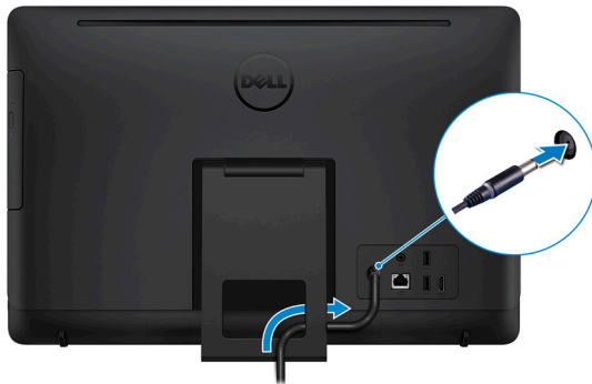
Figur 5. Tilslutning af strømadapteren til staffelfoden
