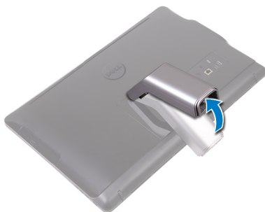
Obrázek 1. Zvednutí riseru stojanu
