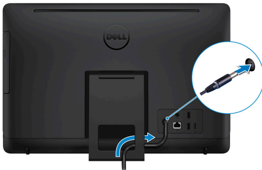
Slika 5. Priključivanje adaptera za napajanje na slikarski stalak
