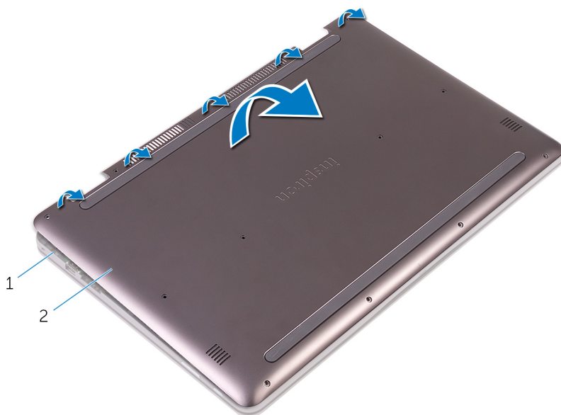
Figura 2. Rimozione del coperchio della base
