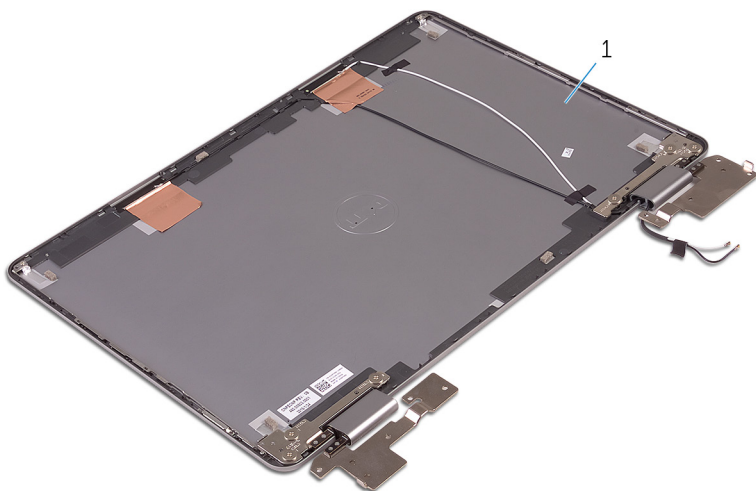
Abbildung 38. Hintere Bildschirmabdeckung und Antennenbaugruppe
