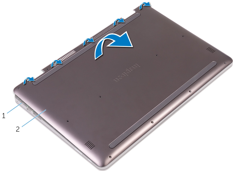
Abbildung 2. Entfernen der Bodenabdeckung
