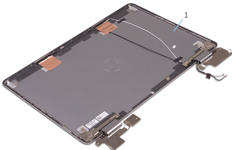
Figur 38. Skærmens bagdæksel og antennemodul
