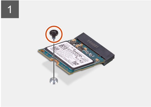
Unità a stato solido M.2 2242
