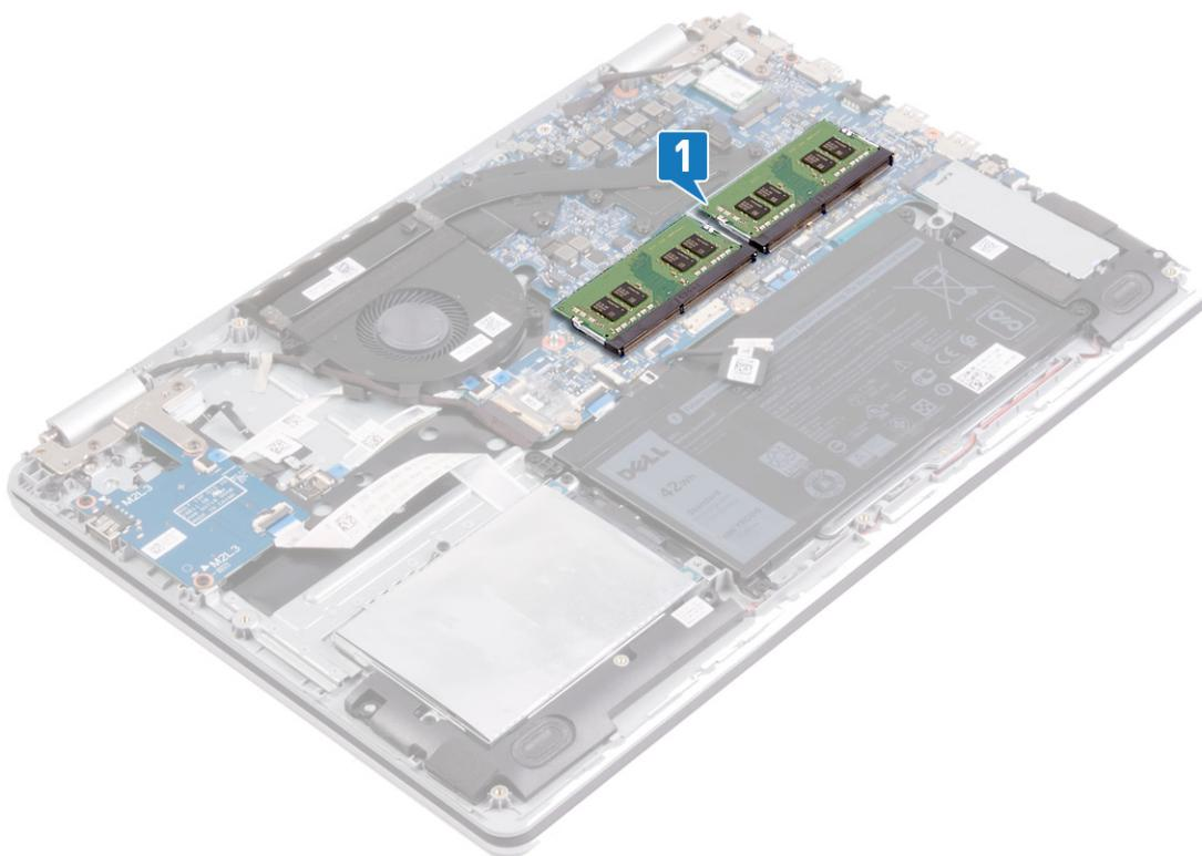
2. Du bout des doigts, écarter délicatement les attaches de fixation situées de chaque côté de l'emplacement de module de mémoire, jusqu'à ce que ce dernier s'éjecte.
