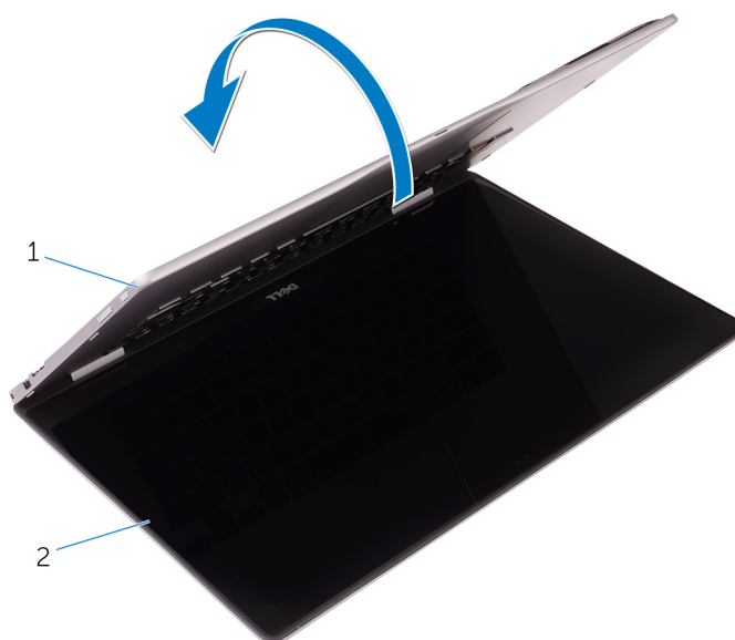
Rysunek 31. Wymontowywanie zestawu wyświetlacza
