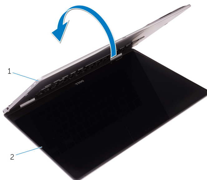
Figura 31. Rimozione del gruppo dello schermo
