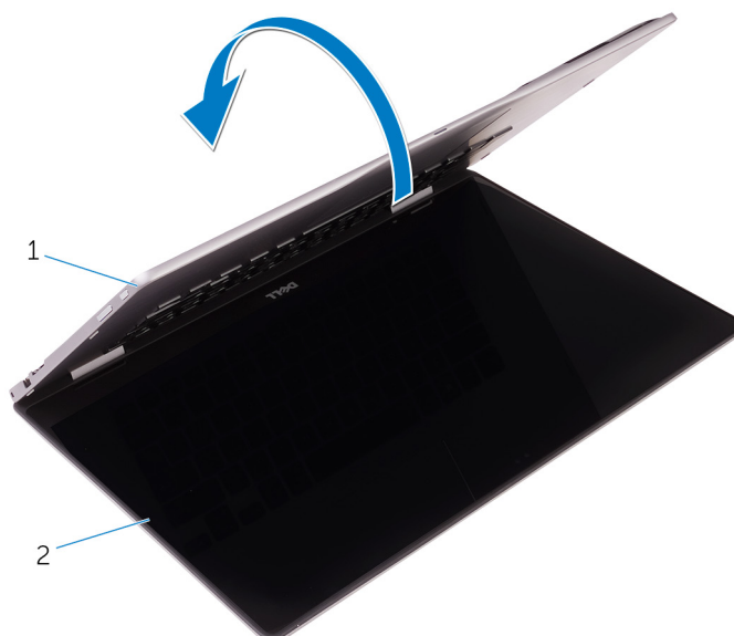
Abbildung 31. Entfernen der Bildschirmbaugruppe
