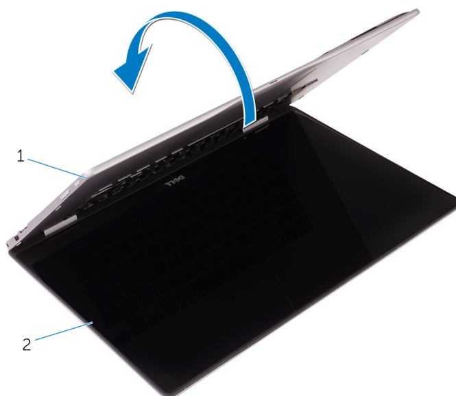
Figura 32. Rimozione del gruppo dello schermo
