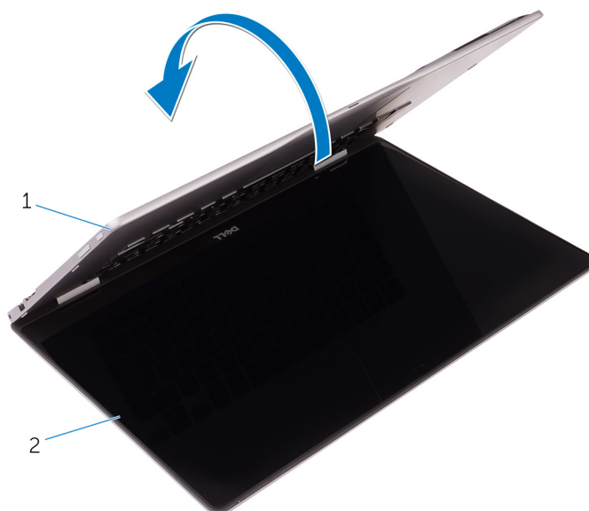
Rysunek 32. Wymontowywanie zestawu wyświetlacza
