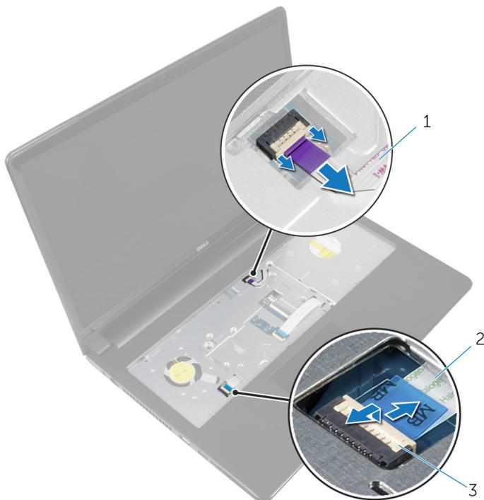
**Figura 26. Como remover a placa do botão liga/desliga e os cabos do touch pad da placa de sistema**
