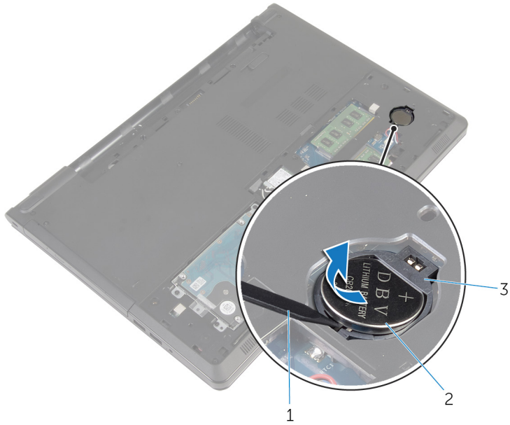
Figure 10. Retrait de la pile bouton
