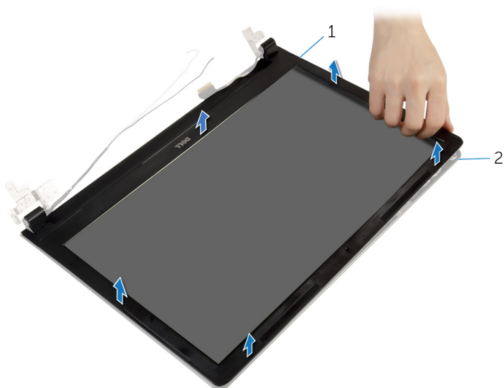
Figura 26. Como remover o bezel da tela
