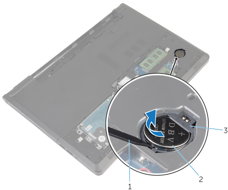
Figura 10. Como remover a bateria de célula tipo moeda
