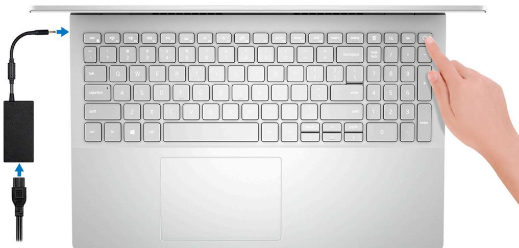
**i** **N.B.:** Per conservare autonomia, la batteria potrebbe entrare in modalità di risparmio energia. Collegare l'adattatore per l'alimentazione e premere il pulsante di alimentazione per accendere il computer.
