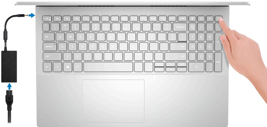
**NOTA:** Para conservar la energía de la batería, es posible que esta ingrese en modo de ahorro energético. Para encender el equipo, conecte el adaptador de alimentación y presione el botón de encendido.
