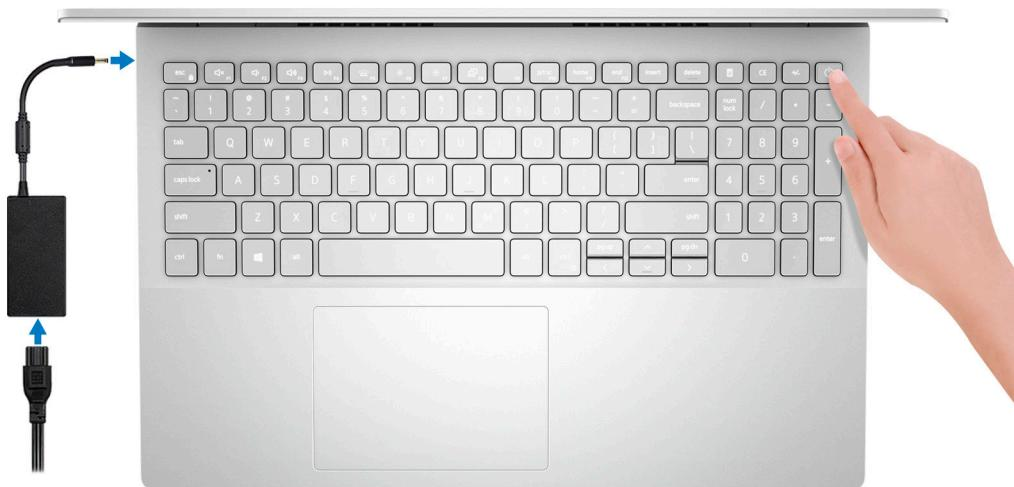
**NAPOMENA:** Da bi se očuvala napunjenošt baterije, baterija može ući u način uštede energije. Priključite adapter napajanja i pritisnite gumb za uključivanje/isključivanje kako biste uključili računalo.
