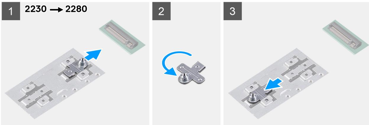
Gambar berikut merupakan representasi visual tentang prosedur untuk memasang braket pemasangan solid-state drive ketika mengganti solid-state drive M.2 2280 dengan solid-state drive M.2 2230 di slot satu M.2.
