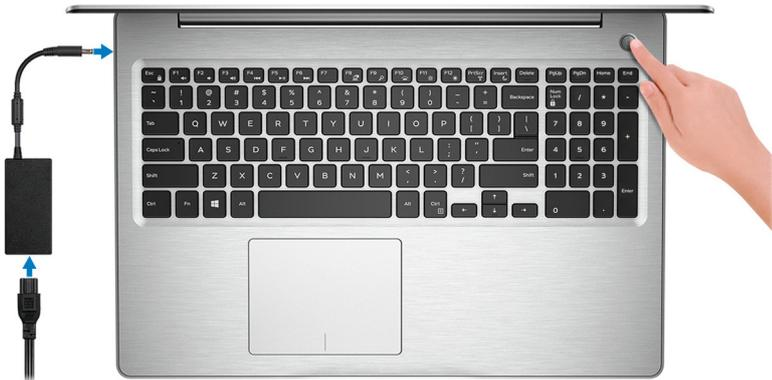
**注：**为了节省电池电量，电池可能进入省电模式。打开电源适配器，并按电源按钮以打开计算机。
