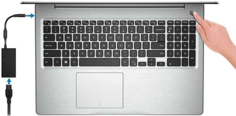
**NOTA:** Para conservar la energía de la batería, es posible que esta ingrese en modo de ahorro de energía. Para encender el equipo, conecte el adaptador de alimentación y presione el botón de encendido.
