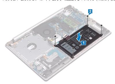
3 バッテリーケーブルをシステム基板に接続します。
