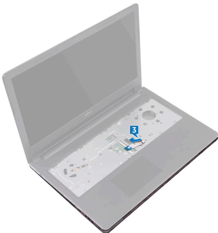
4. Deslize as abas na tampa da base, inserindo-as nos encaixes no conjunto do apoio para as mãos, e encaixe a tampa da base no lugar.
