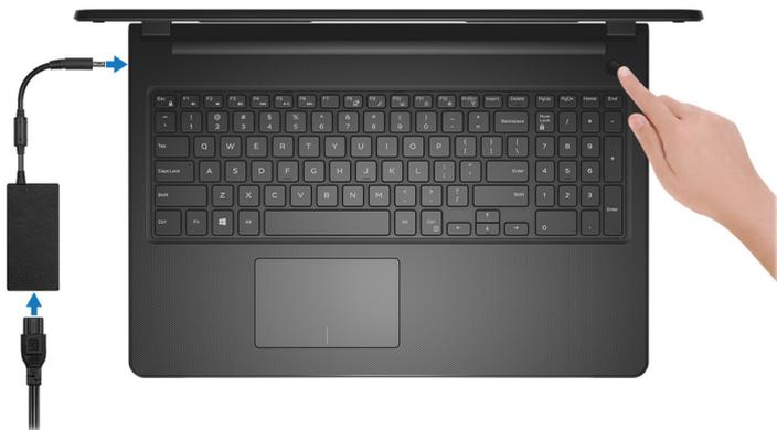
图 1: 连接电源适配器，然后按下电源按钮。
