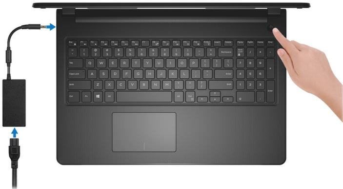
Figura1. Ligue o adaptador de energia e prima o botão de alimentação
