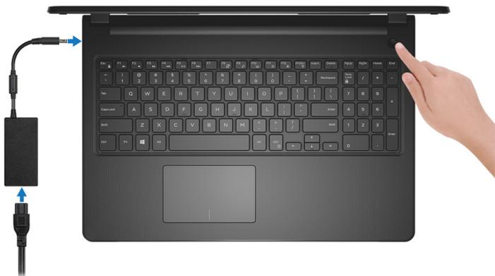
Figura 1. Conecte o adaptador de energia e pressione o botão liga/desliga.
