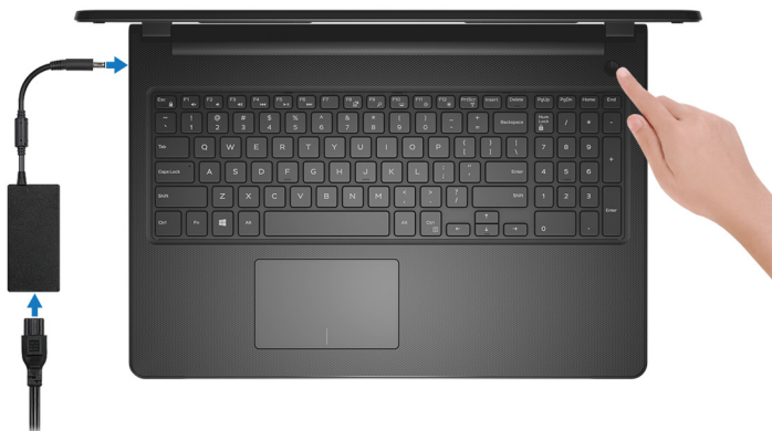
Skica 1. Priključite napajalnik in pritisnite gumb za vklop.
