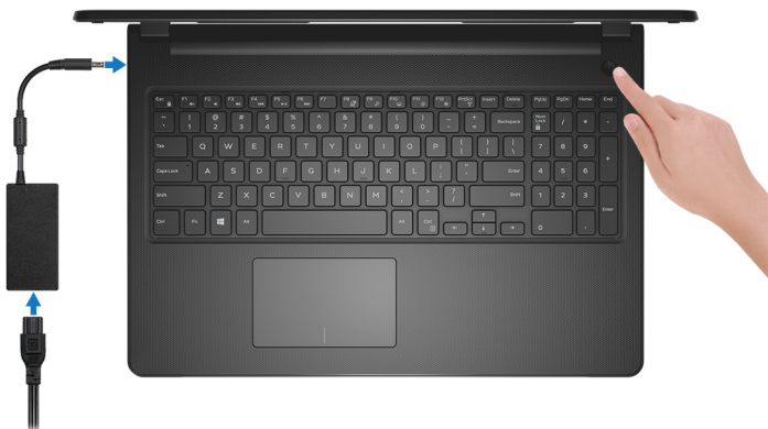
Figur 1. Anslut nätadaptern och tryck på strömbrytaren
