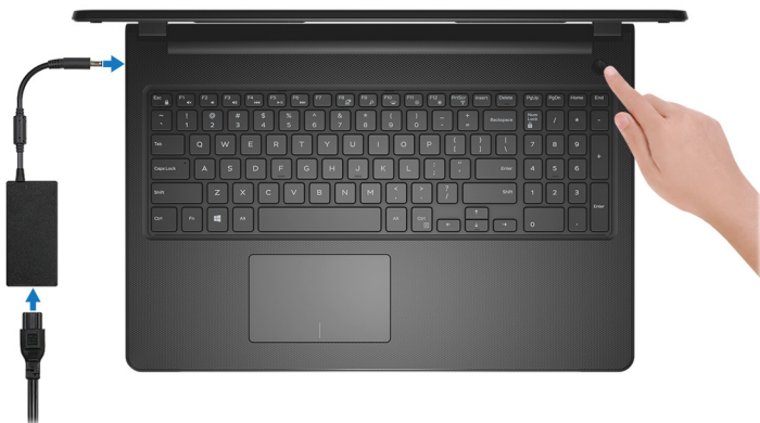
Αριθμός 1. Σύνδεση του προσαρμογέα ισχύος και πάτημα του κουμπιού λειτουργίας
