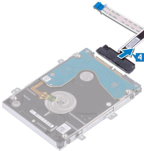
5 Extraiga los cuatro tornillos (M3 x 3) que fijan el soporte de la unidad de disco duro a la unidad de disco duro.
