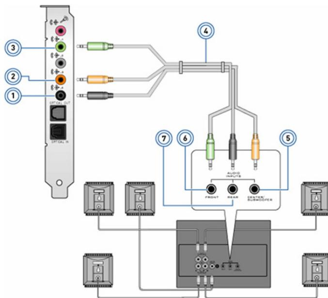
図 1. 5.1 スピーカーの接続
