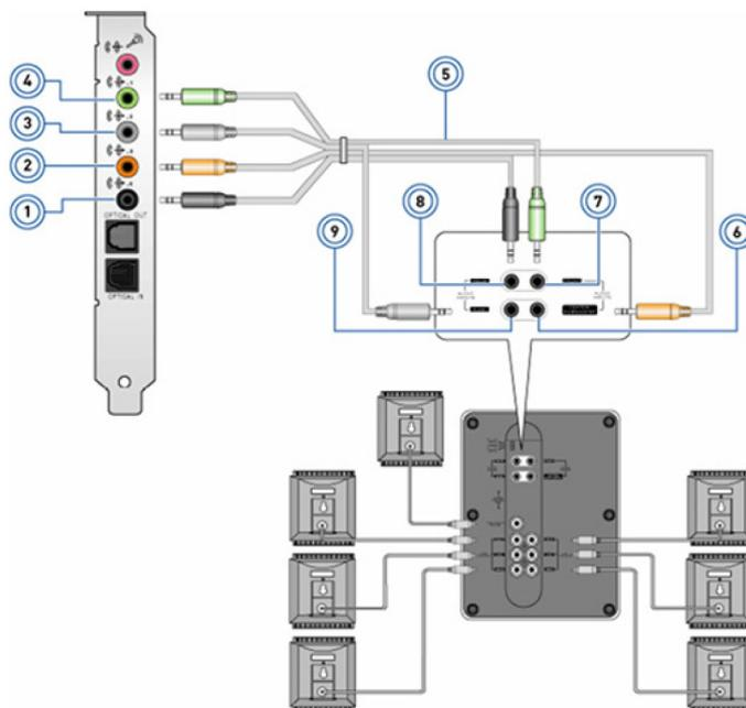
図 2. 7.1 スピーカーの接続
