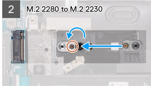
L'image suivante indique l'emplacement du disque SSD M.2 2280 et fournit une représentation visuelle de la procédure d'installation.
