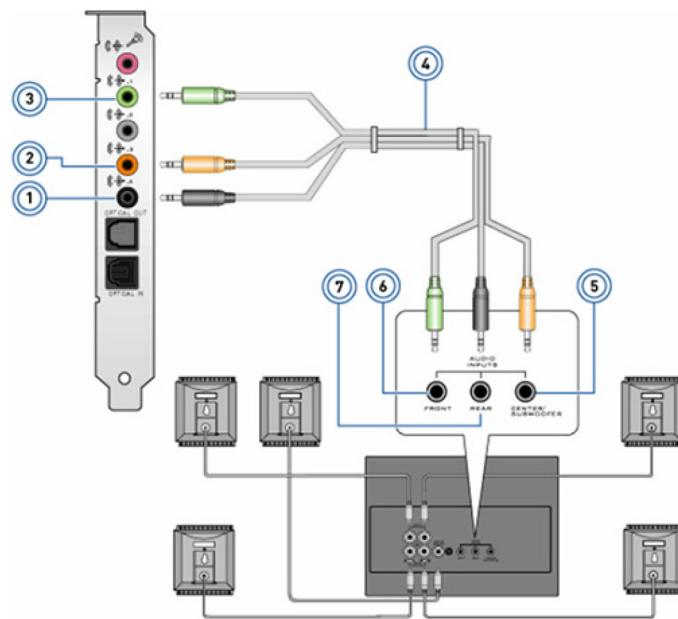
Obrázok 1. Pripojenie reproduktorov typu 5.1
