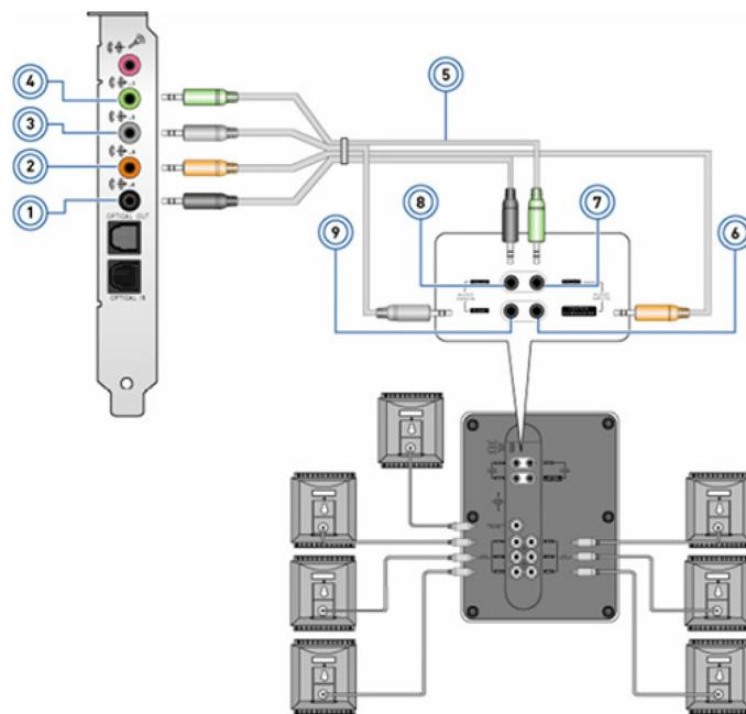
Obrázok 2. Pripojenie reproduktorov typu 7.1
